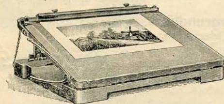
Außerdem wird durch eine automatische Pressung ein durchaus gerader sicherer Schnitt gewährleistet.
