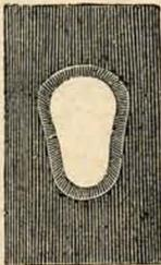
Dieselben werden beim Copiren auf das Negativ aufgelegt und dienen zur Herstellung einer gleichmässigen Abtönung der Portraits nach dem hellen Rande zu.
